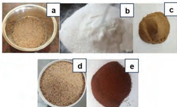
Fig. 1 (a) Organic waste (b) Plastic waste (c) Clay (d) Sand (e) Red earth
